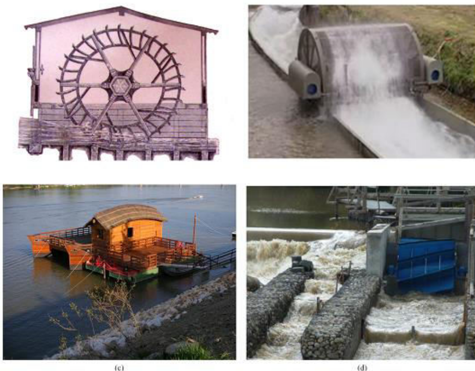
3-расм. Оқимли сув гилдираклари: (а) субкритик саёз оқим (Қуаранта, 2017), (б) суперкритик саёз оқим (Емануеле Қуаранта фотосурати), чуқур оқим (АИАМС фотосурати. Италия) (с) ва Гидростатик босим машинаси (Ник Линтоннинг расми) (Линтон, 2013) пичоқларда тортишни камайтириш учун диагонали пичоқлар (d).
